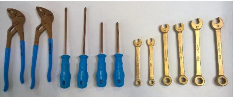
Bild 64: Zulässiges Werkzeug für die Montage in Ex-Bereichen
