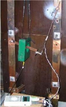
Prüfung mit Temperaturfühlern
